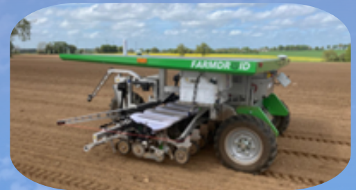
Denne nye 100 % autonome landbrugsrobot sår persille – få dage senere udfører den også mekanisk ukrudtsbekæmpelse.
